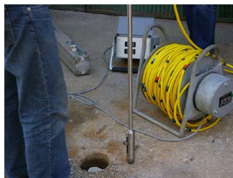
Слика 7. Опрема за инклинометарски мерења на поместувања во свлечишта
