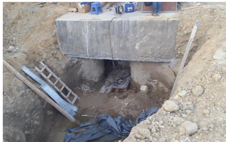
Слика 5.21. Реакционен систем за обезбедување на контра-товар, Е1
