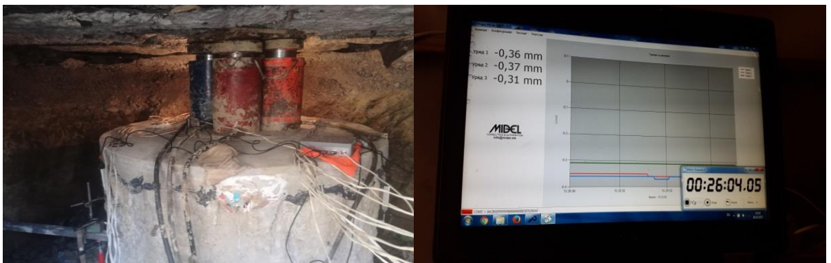
Слика 5.36. Приказ на реакционен систем (опрема и резултати), Е1
