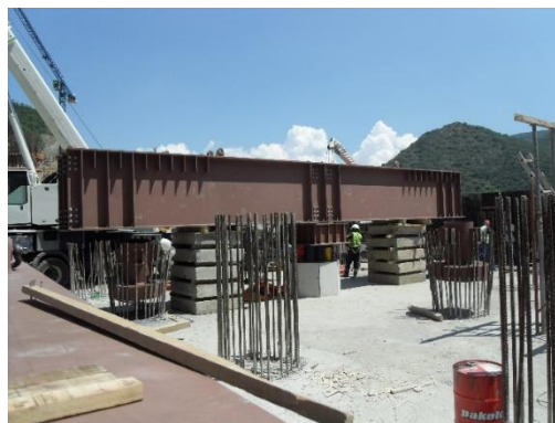
Слика 5.25. Приказ на реакционен систем со челична греда при испитување со статичко товарење, Е3
