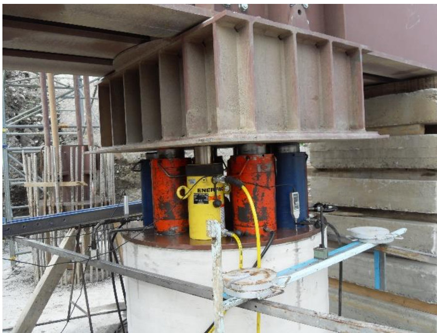
Слика 5.6. Целосна мерна техника за аквизиција на деформации и нанесување на товар при испитување на моделите
