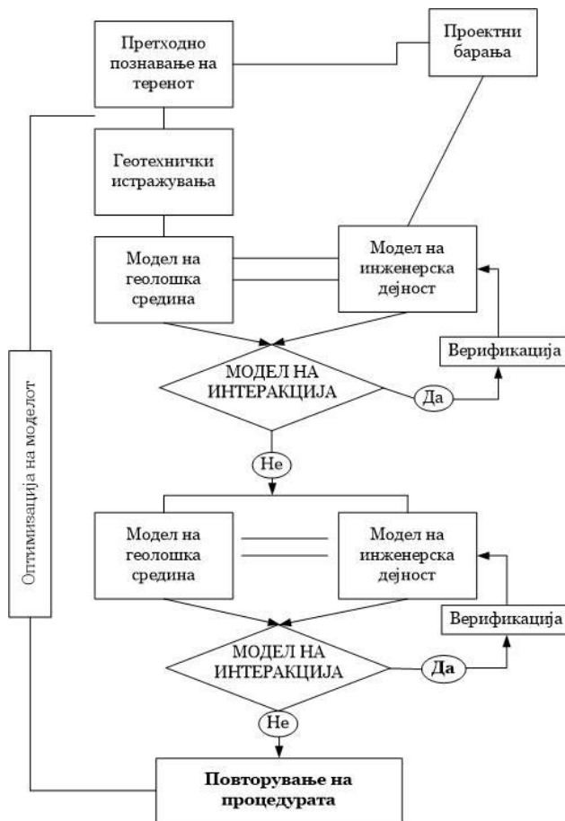
Слика 4.4. Структура на геотехнички модел (Павловиќ, 1996)
