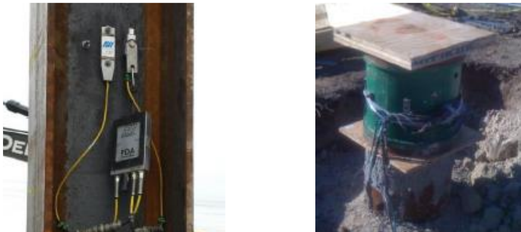
Слика 4.11. (а) Забрзување (десно) и конвертор на напрегања (лево) на кол за мерење на сила и брзина со безжичен предавател, (б) обезбеден со потребната опрема - конвертор на врвот
