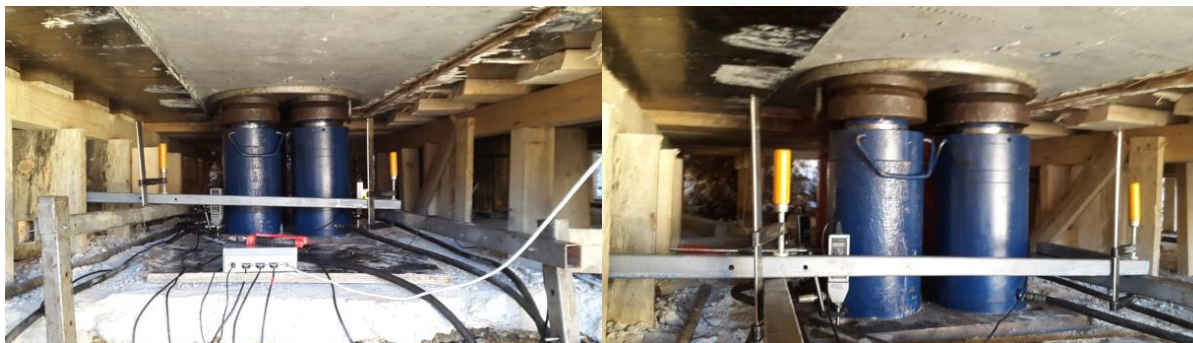
Слика 5.42. Приказ на опрема за испитување на кол тестот, Е2
