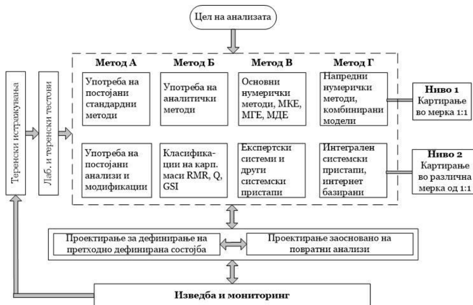
Слика 4.5. Дијаграм за дефинирање на процес на моделирање во инженерската механика на карпи (Фенг и Хадсон, 2011)
