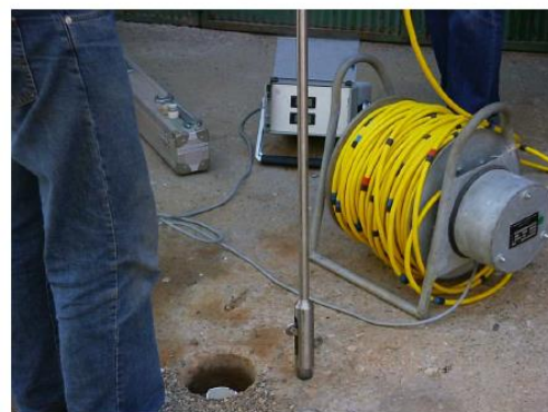
Слика 7. Опрема за инклинометарски мерења на поместувања во свлечиста
