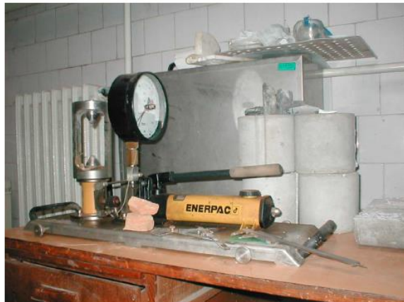
Слика 5. Опрема за испитување на точката јакоста на карпи
