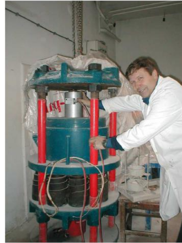
Слика 3. Опрема за испитување на деформабилност на грубозрни почви
