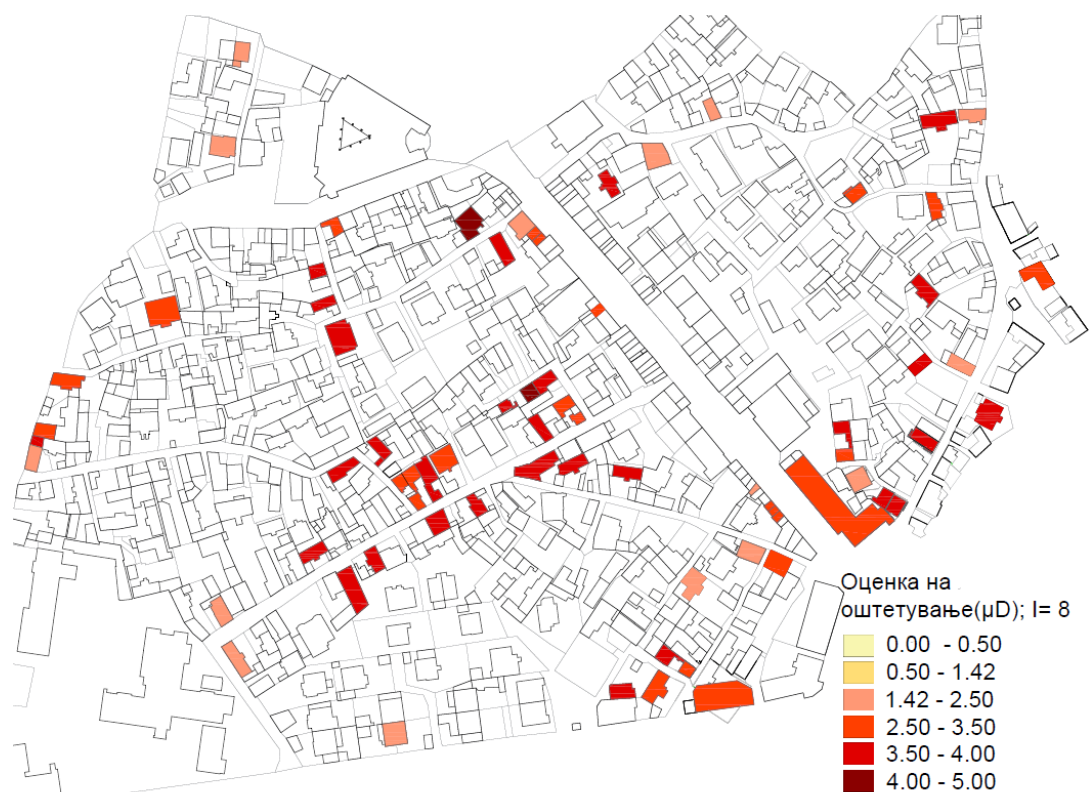
Слика 60 - Просторната распределба на средното ниво на оштетување за I=8 на земјотрес за објектите во Дебар (Ferreira)
