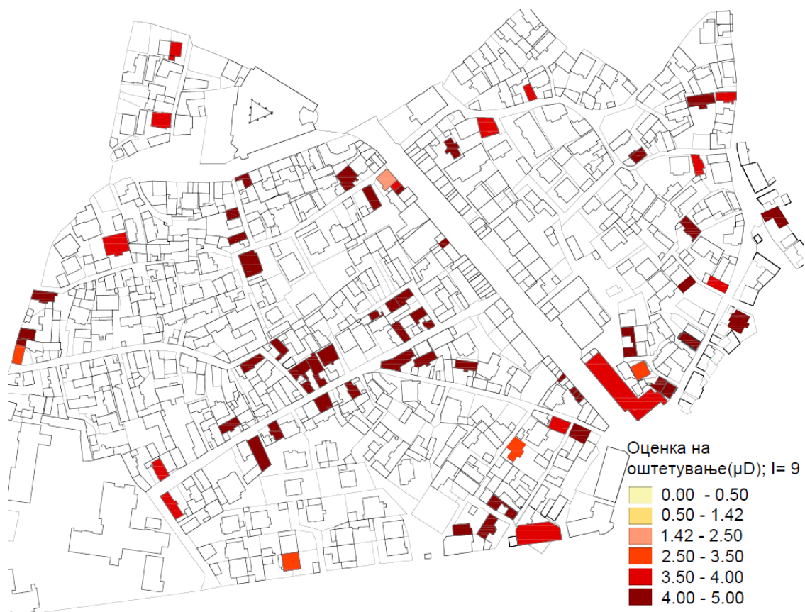
Слика 61 - Просторната распределба на средното ниво на оштетување за I=9 на земјотрес за објектите во Дебар (Ferreira)
