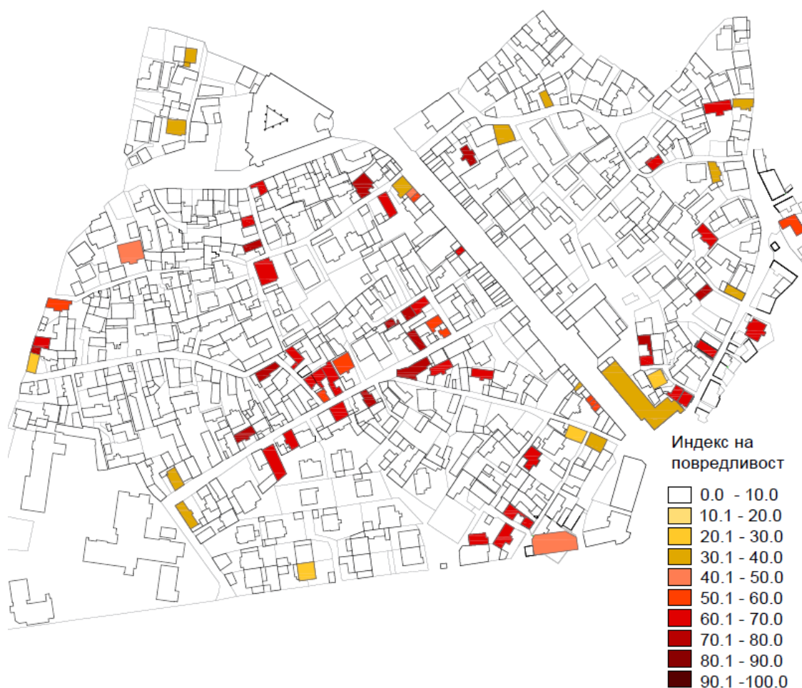
Слика 48 - Просторна распределба на објектите според ( I_{vf} ), за постојна состојба на објектите во Дебар, според тежинските фактори на Ferreira
