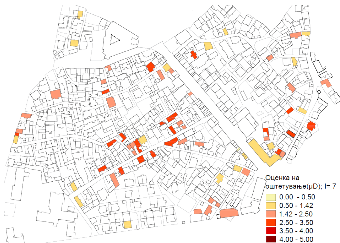
Слика 59 - Просторната распределба на средното ниво на оштетување за I=7 на земјотрес за објектите во Дебар (Ferreira)
