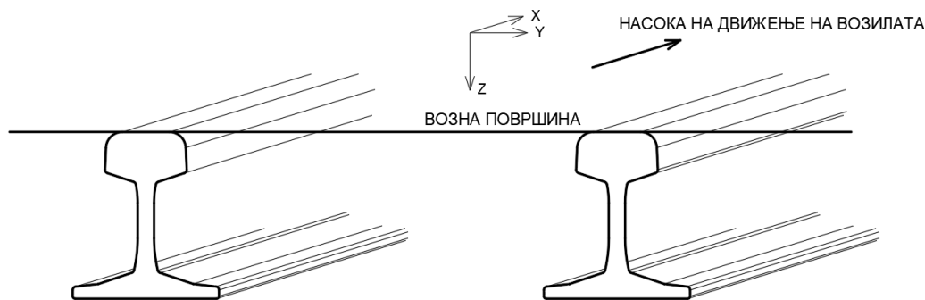
Слика 13. Главни оски на координатниот систем на колосекот
