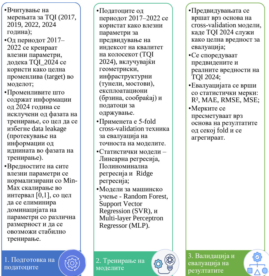
Слика 46. Преглед на фази во процесот на моделирање: подготовка на податоци, тренирање на модели и валидација
