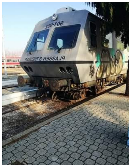
Слика 33. Мерна кола EM 80L, за мерење на параметри на геометрија на колосек (Извор: [73])
