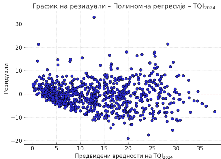
Слика 57. График на резидуали за полиномен регресиски модел за TQI_{2024} (Извор: сопствени пресметки)
