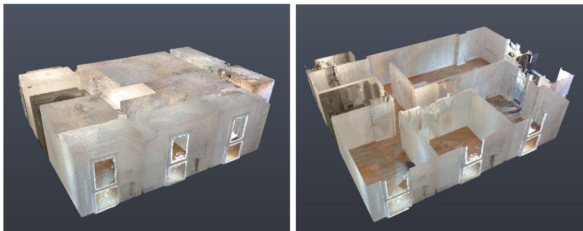
Слика 7.3. Обработен облак од точки добиен со ласерско скенирање на станот со рачен SLAM скенер
