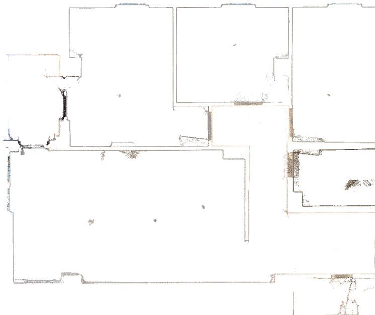
Слика 74. Хоризонтален пресек на облакот од точки во ВІМ околина
