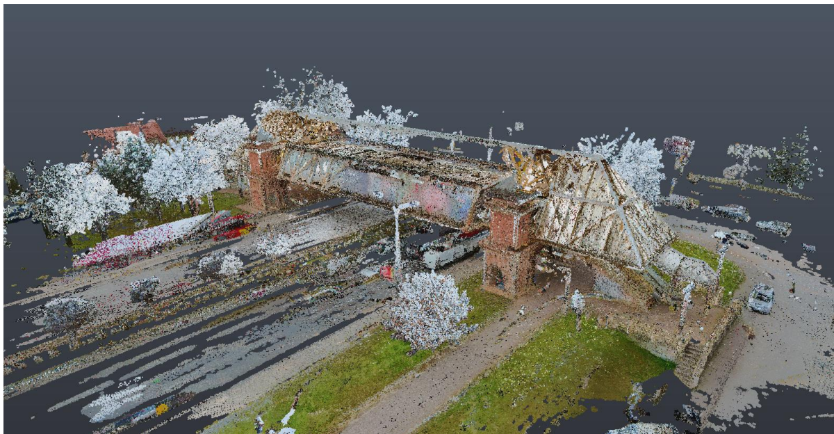
Слика 7.14. Интегриран облак од точки добиен со ласерско скенирање на мост „Влајко“
