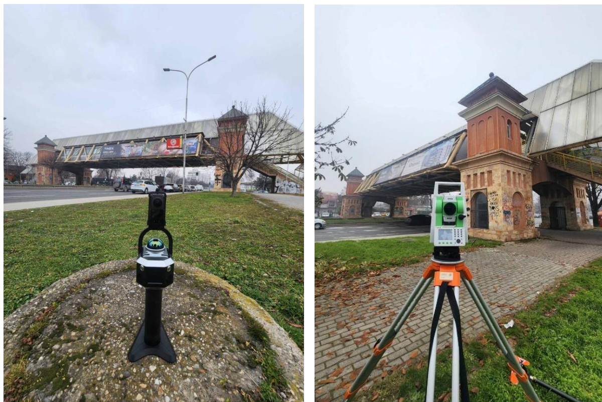
Слика 7.13. Снимање на мост „Влајко“, лево – рачен скенер, десно – тотална станица
