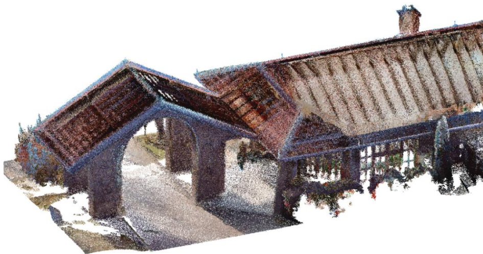
Слика 7.30. Облак од точки добиен со ласерско скенирање со SLAM рачен скенер за селектираниот објект
