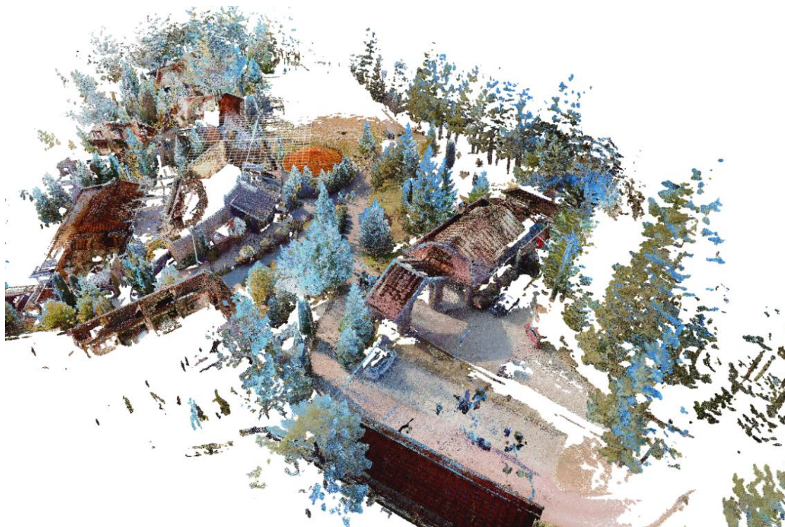
Слика 7.28. Облак од точки добиен со ласерско скенирање со SLAM рачен скенер од хотелскиот комплекс
