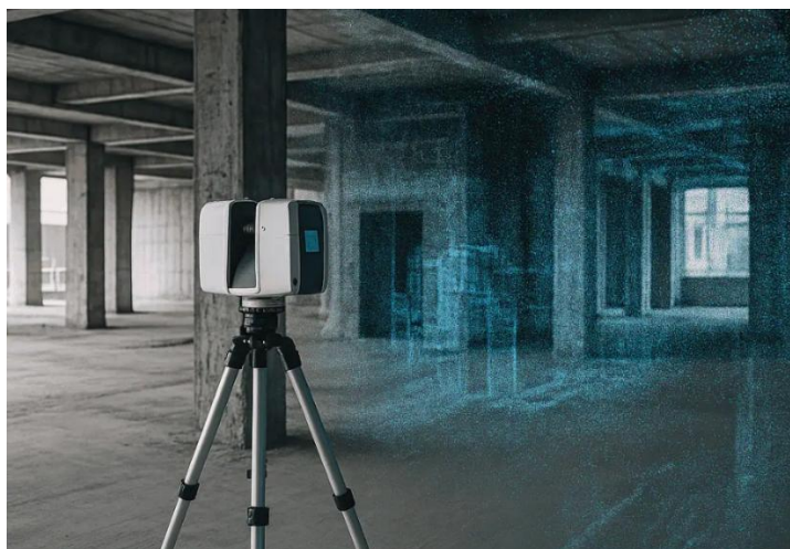
Слика 5.2. Терестрички ласерски скенер (TLS)
