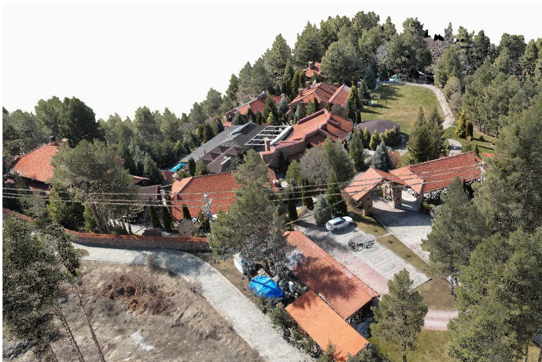
Слика 7.27. Облак од точки добиен со LiDAR скенирање од воздух од хотелскиот комплекс
