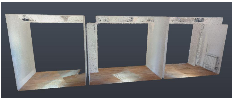
Слика 75. Вертикален пресек на облакот од точки добиен со ласерско скенирање на станот
