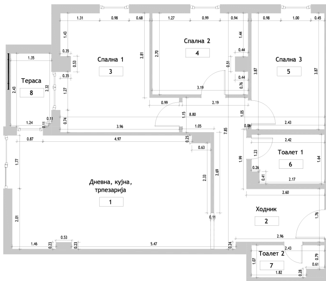
Слика 7.10. Должини [m] извлечени од BIM модел
