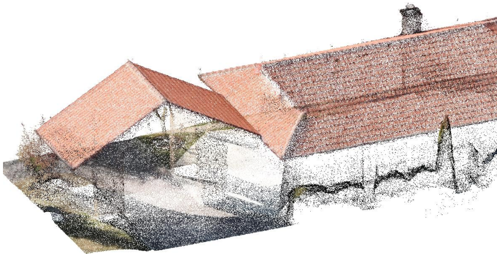
Слика 7.29. Облак од точки добиен со LiDAR скенирање од воздух за селектираниот објект
