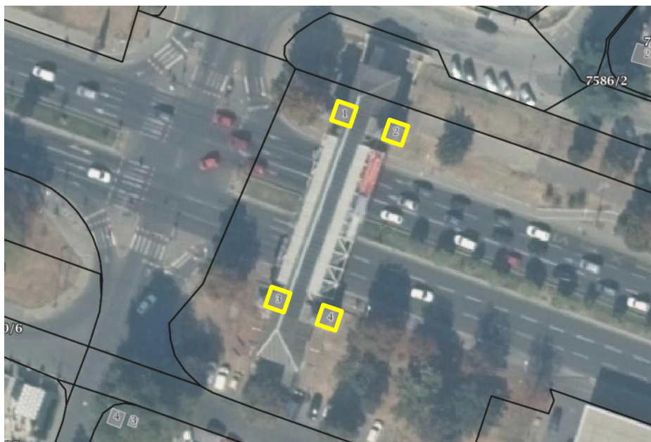
Слика 7.12. Ортофотото снимка и регистрирани катастарски парцели и објекти (жолти полигони – регистрирани објекти (столбови) на мост „Влајко“)
