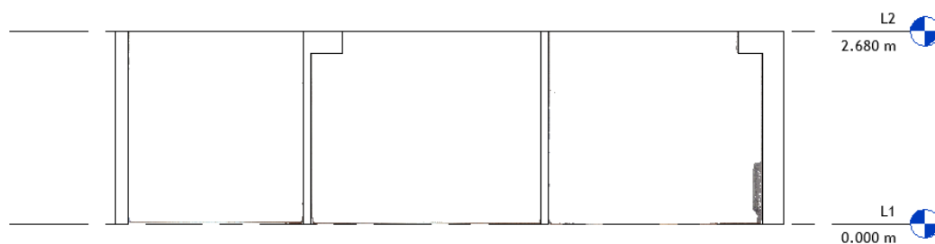
Слика 7.6. Вертикален пресек на облак од точки и BIM модел на станот
