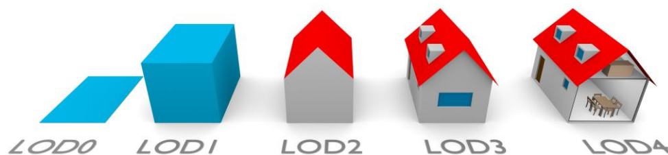
Слика 2.5. Нивоа на деталност (LOD) во GIS (Извор: Biljecki et al., 2013)
