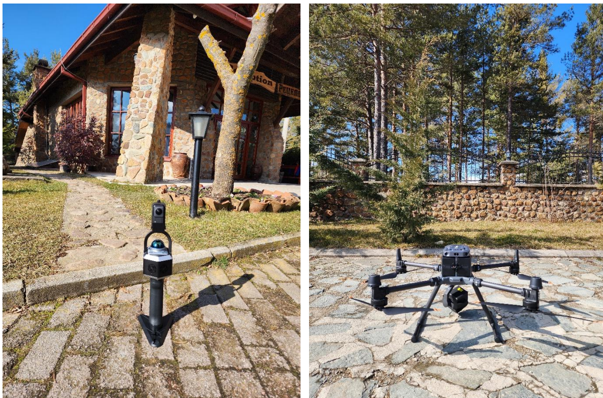
Слика 7.25. Скенирање на хотелски комплекс, лево – рачен скенер, десно – беспилотно летало со LiDAR скенер
